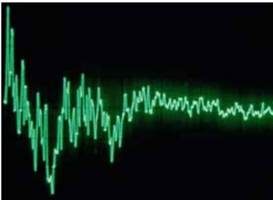
Figure 25: détonation produite par le déclenchement d'un airbag, niveau de pression acoustique de crête  $L_{\text{peak}} = 160 \text{ dB(C)}$ .
