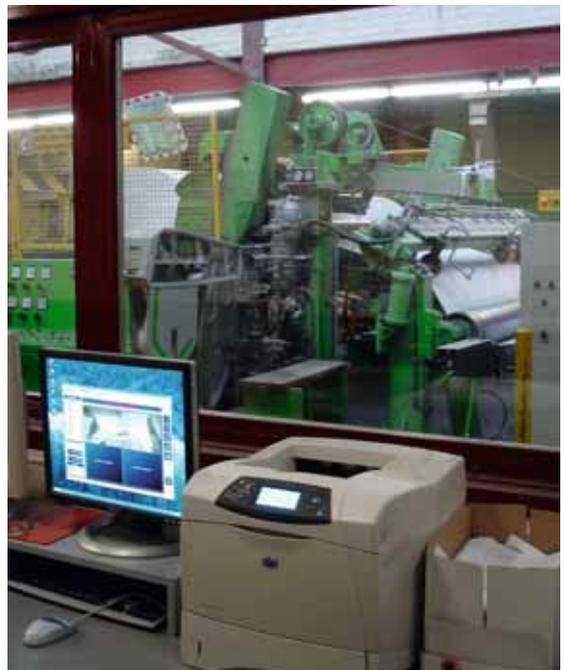
Figure 75: local de commande d'une machine à papier. Le bruit de fond dans le local de commande s'élève à 65 dB(A), contre 90 dB(A) à l'extérieur du local.
