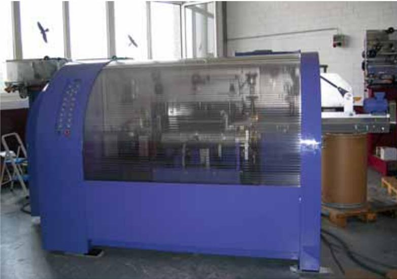
Figure 72: encoffrage d'une machine fabriquant des boîtes de conserve. Le niveau sonore sur la partie externe de la machine a été réduit à 82 dB(A).
