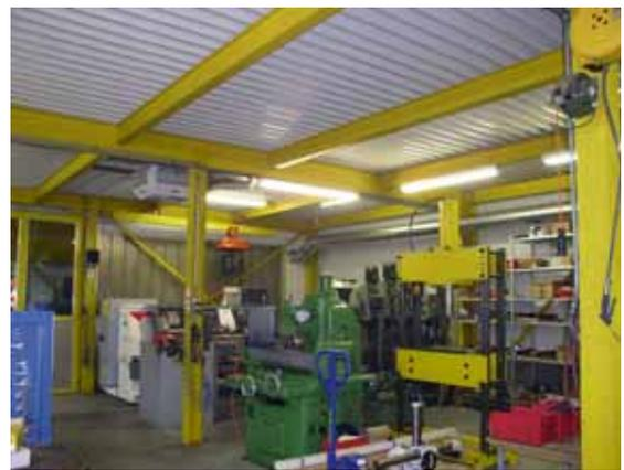
Figure 79: local de fabrication courant: structure métallique avec tôle profilée, sans plafond acoustique efficace. Ce local est très réverbérant. Le bruit des machines est très gênant dans tout le local.
