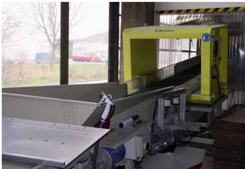
Figure 76: bande transporteuse d'un broyeur de déchets de plastique.
