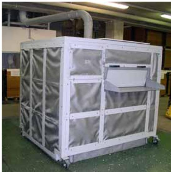
Figure 71: encoffrage d'un broyeur de déchets plastiques. Le niveau sonore a baissé d'environ 12 dB(A).
