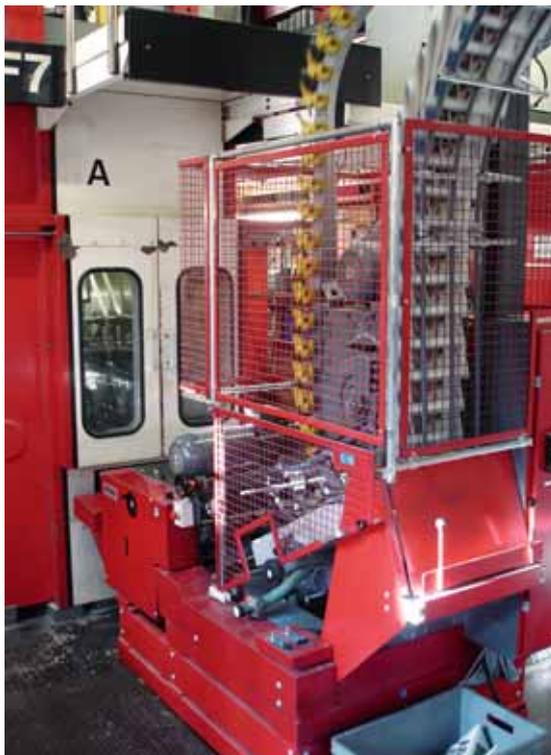
Figure 73: rotative à la plieuse encoffrée. Le niveau sonore est réduit de 98 à 84 dB(A).
