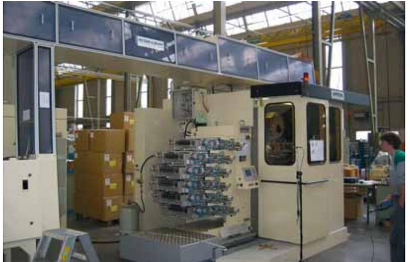
Figure 70: encoffrage partiel d'une machine d'impression de tubes (200 tubes/min); on mesure à 1 m de distance encore un niveau sonore de 77 dB(A).
