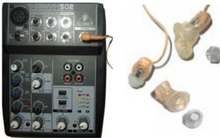
Bei dieser besteht die Möglichkeit, Otoplastiken (z.B. Elacin ER-15) für das In-Ear-Monitoring zu verwenden, wobei der Filter nicht mehr benötigt wird, da dieser durch „Kopfhörer“ ersetzt wird, die an einen Mischpult angeschlossen werden. Bei dieser Ausführung belaufen sich die Kosten für das Mischpult (ca. 80 Franken) und für passenden In-Ear-Monitoring
