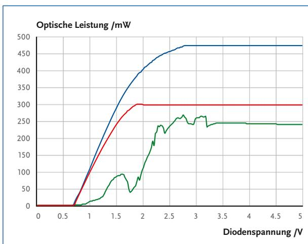
5 Die optische Leistung ist nicht direkt proportional zur Diodenspannung und muss für jede Farbe einzeln gemessen werden.
