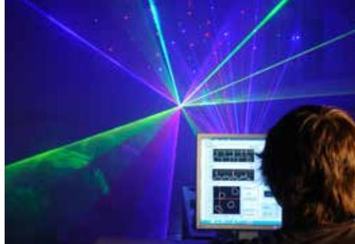
Um Augenschäden zu vermeiden, überprüft der vom METAS entwickelte Laser Show Risk Analyzer (LASRA) die Einhaltung der Grenzwerte.
